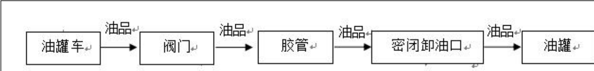
图 2.5-4 柴油卸油工艺流程图
